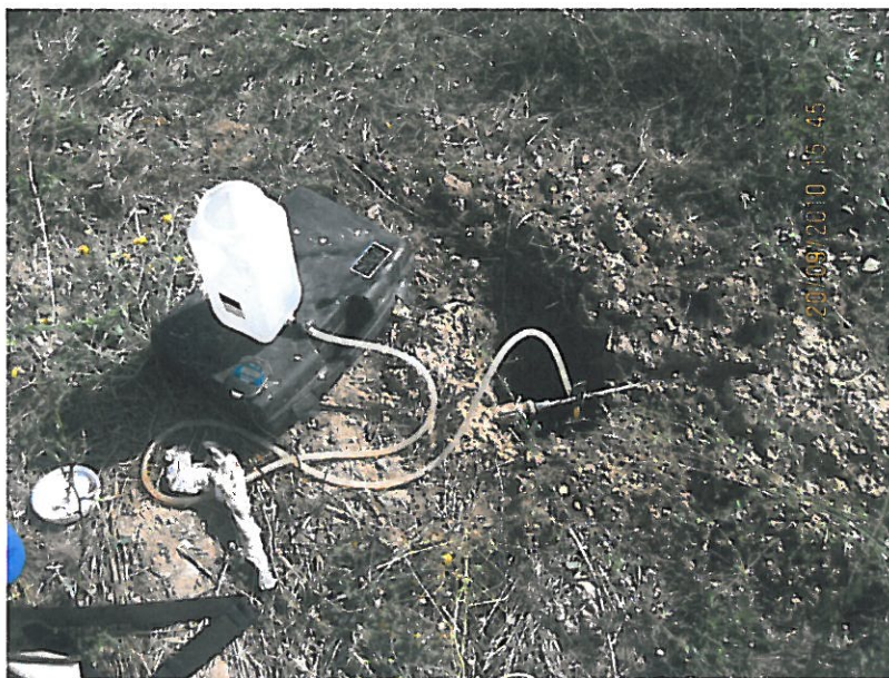
Figure 2: Dispositif Porchet de mesure de perméabilité des sols
