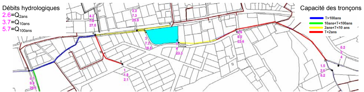
Figure 47 : Débits hydrologiques et capacité du réseau-Etat actuel
